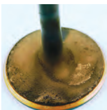
↑ Ventil po 60 h na standardní palivo.
