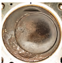
↑ Píst po 60 h na standardní palivo.
