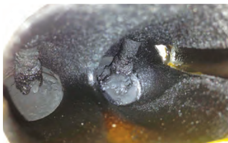
↑ Sací kanály vozu jezdícího na benzin standardní jakosti.
