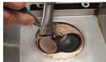
← Ventil po 60 h na standardní palivo.
