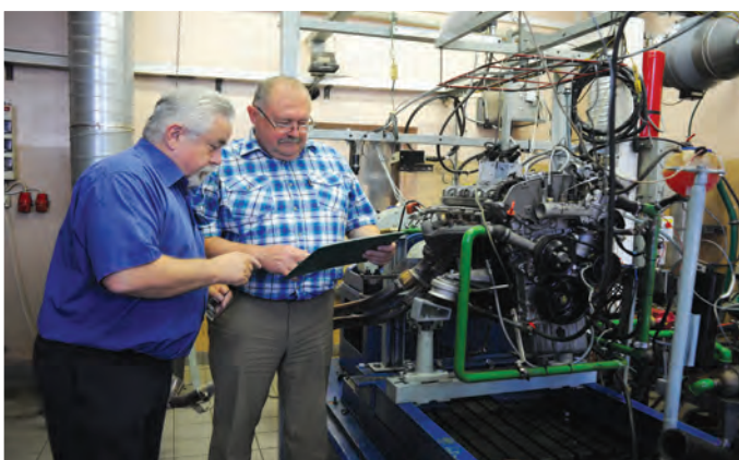
↑ Miloslav Železný ze společnosti VIF s Ivo Krajíčkem, vedoucím motorové zkušebny SGS. Právě probíhající zkouška ověřuje novou recepturu aditiva pro velkého prodejce pohonných hmot, který chce nabízet prémiový benzin.
