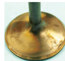
← Aditivované palivo zcela vyčistilo ventil z předchozí zkoušky.
